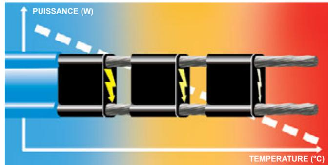
**NB :** contrairement aux autres éléments résistifs, il est impossible de contrôler l'intégrité fonctionnelle d'un câble autorégulant à l'aide d'une mesure de résistance à l'ohmmètre. C'est en revanche possible en mesurant le couple tension/courant.
