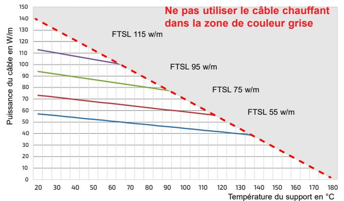
La courbe ci-dessus représente la puissance en w/m en fonction de la température du support. Le câble chauffant doit être recouvert à 100% par un adhésive aluminium et installé sur un support métallique. Consulter notre service technique pour tous renseignements
